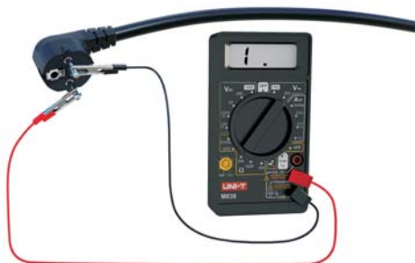
Измерение сопротивления токопроводящей жилы
