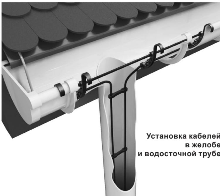
Установка кабелей в желобе и водосточной трубе
