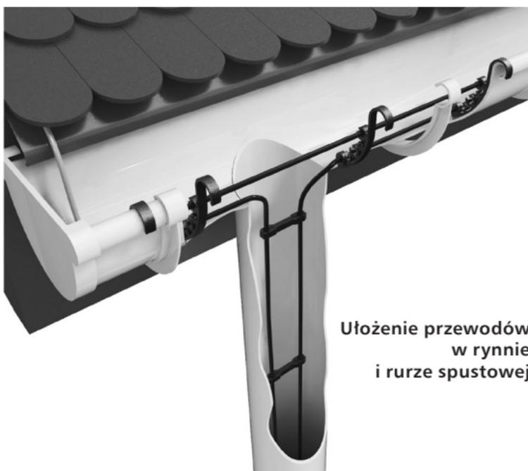
Ułożenie przewodów w rynnie i rurze spustowej
