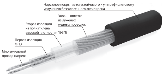
Конструкция кабеля нагревательного мата ELEKTRA SnowTec® Tuff
