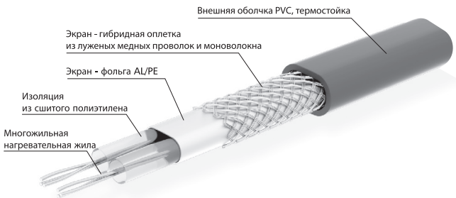
Конструкция нагревательного мата ELEKTRA SnowTec®
