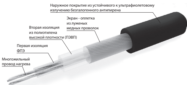
Конструкция нагревательного кабеля ELEKTRA TuffTec™
