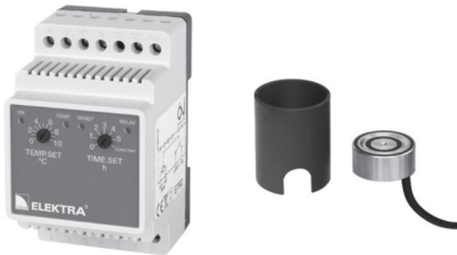
Терморегулятор ELEKTRA ETR2G – нагрузка 16 А. Если мощность системы больше 3600 Вт необходимо использовать контактор. Стандартная комплектация с одним датчиком температуры и влажности с цилиндрическим основанием.
