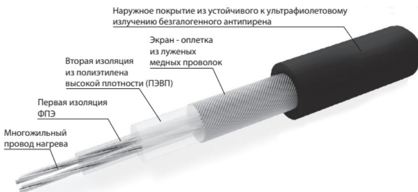
Конструкция нагревательного кабеля ELEKTRA TuffTec™
