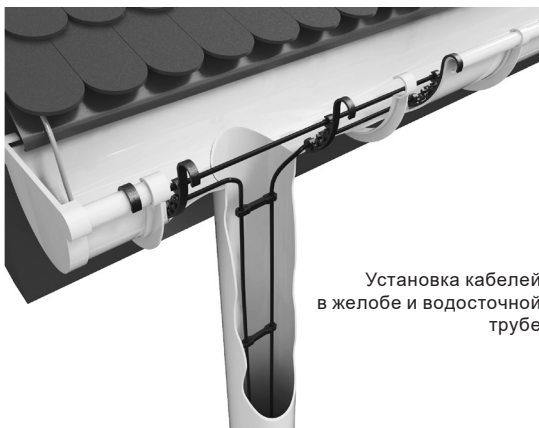
Трос с клипсами для водосточных труб DSW-2
