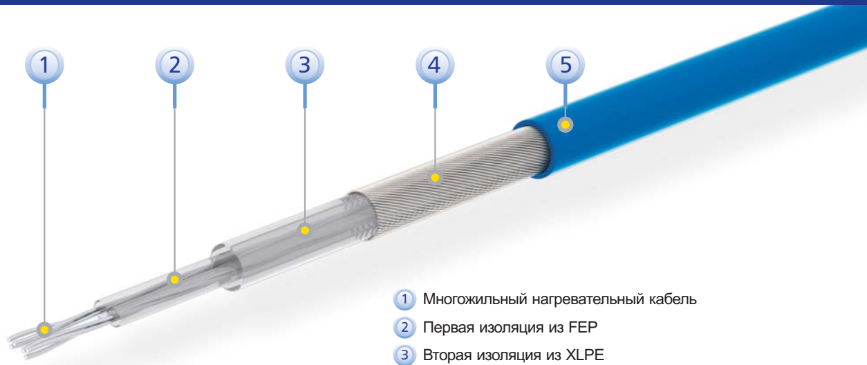
Структура нагревательного кабеля нагревательного мата ELEKTRA MD
