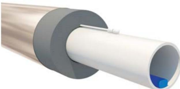
Нагревательный кабель установлен в трубе
