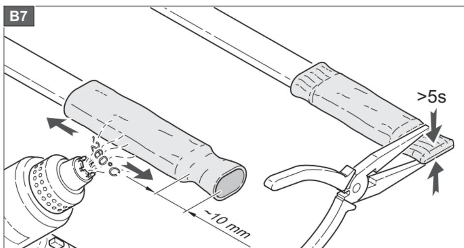
Zgrzać koszulkę dmuchawą gorącego powietrza o temperaturze 260°C.
