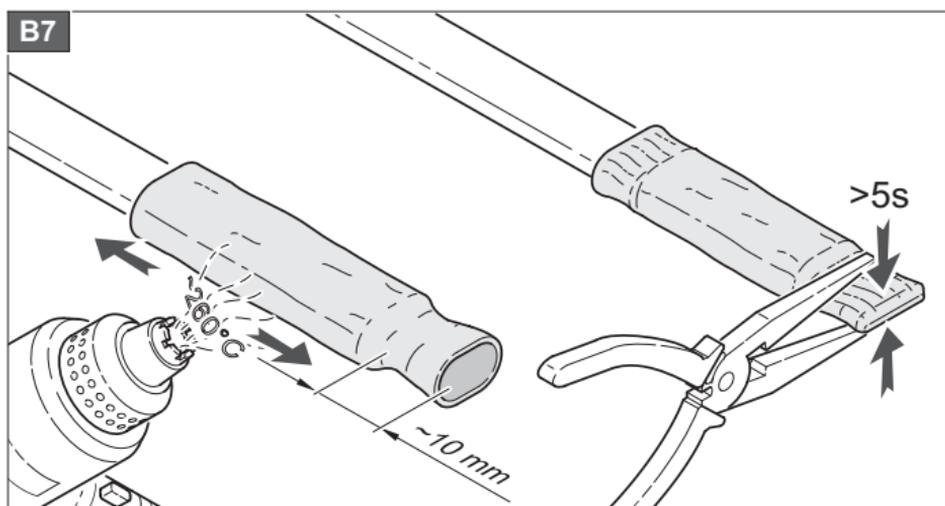
Schrumpfen Sie die Röhre mit der Heißluftpistole (mit der Temperatur 260°C).
