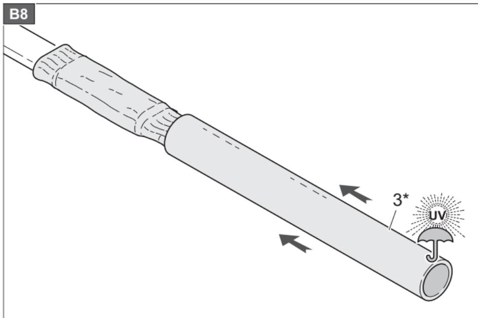
Наденьте термоусадочную трубку 3 (рис. Z1) на  $\frac{3}{4}$  ее длины.
