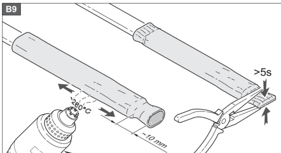
Zgrzać koszulkę dmuchawą gorącego powietrza o temperaturze 260°C.
