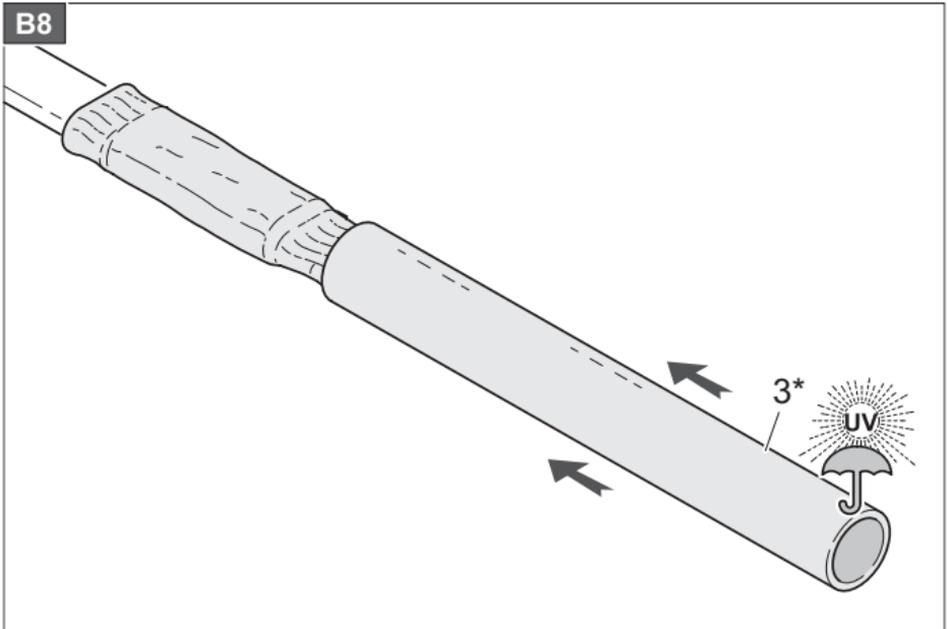
Ziehen Sie die hitzeschrumpffähige Röhre 3 (Abb. Z1) zu  $\frac{3}{4}$  auf das Kabel.
