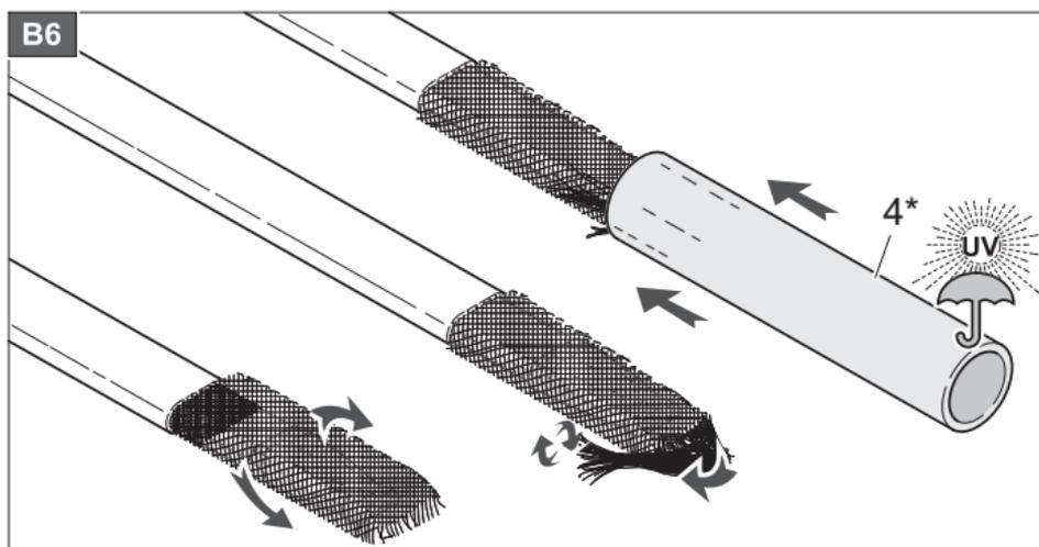
Entrollen und verdrehen Sie den Schutzschirm über die hitzeschrumpffähige Röhre um die Dämmung wiederherzustellen.
