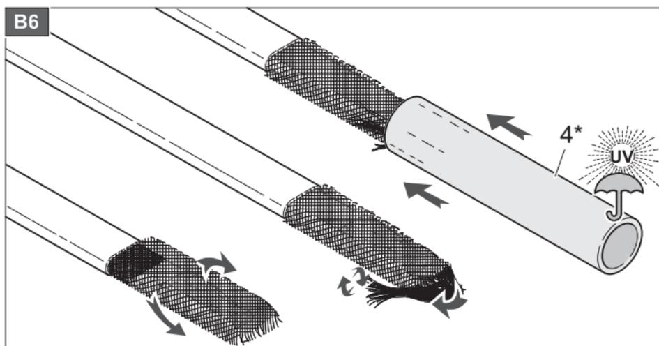
Odwinąć i skrócić ekran ochronny na koszulce termokurczliwej odtwarzającej izolację.
