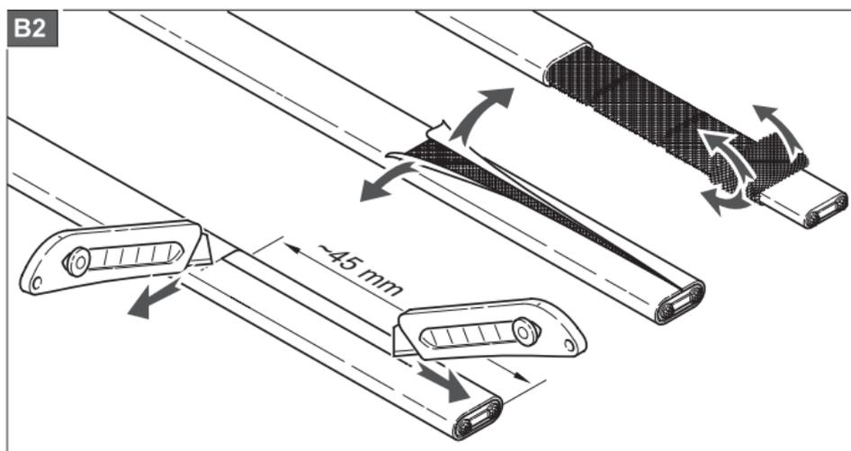
Spalten Sie die Kabelhülle vorsichtig längsseits auf einer Länge von 45 mm ohne dabei den Schutzschirm zu beschädigen. Entfernen Sie dann die Hülle.
