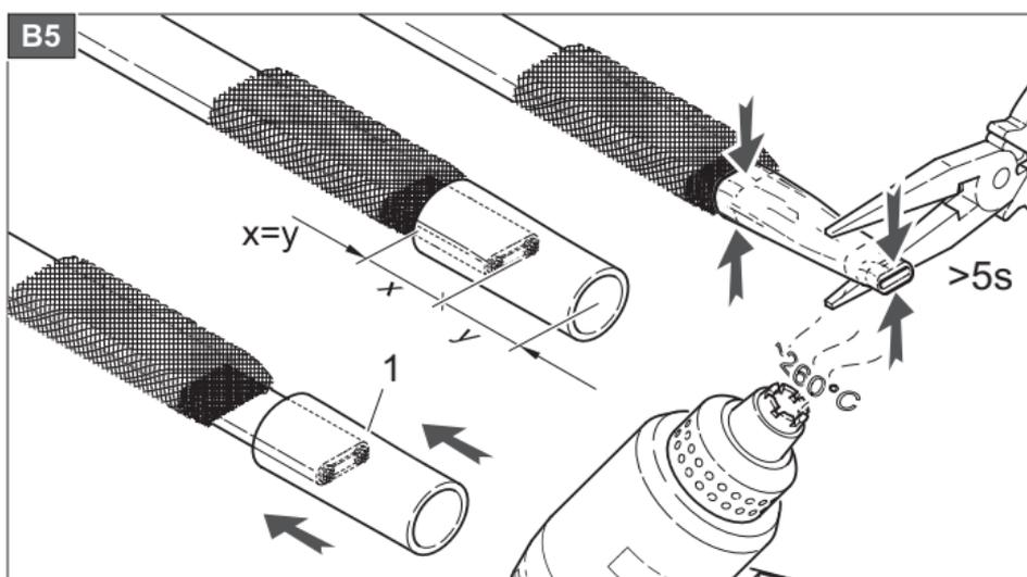
Наденьте термоусадочную трубку 1 (рис. Z1)
