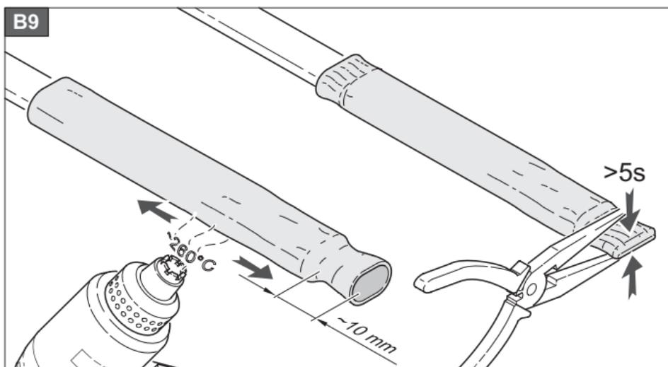
Используя строительный фен, усадите трубку горячим воздухом (температура - 260°C).
